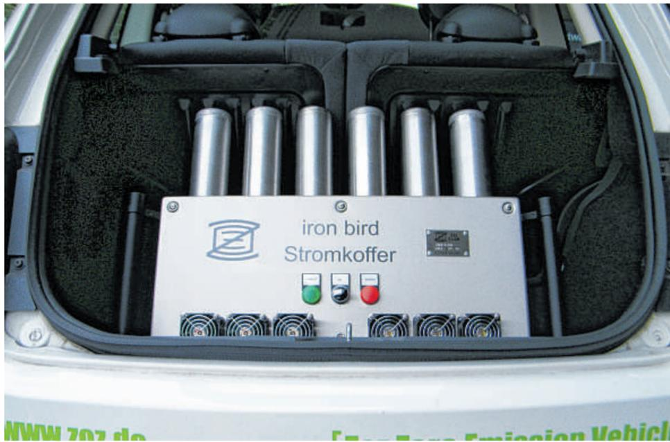
Der Stromkoffer der Firma Zoz, der mit sechs Wasserstoffkartuschen und einer kleinen Brennstoffzelle ausgestattet ist und im Kofferraum jedes Elektroautos mitgeführt werden kann.
